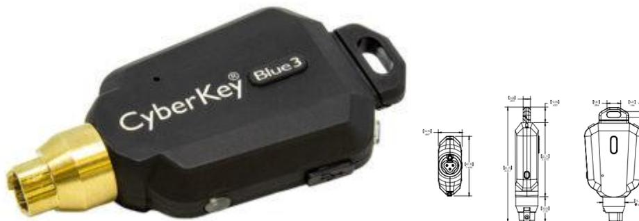
CyberKey Blue 3 verwendet ein Bluetooth 5.0-zertifiziertes Radio. LE-gesicherte Verbindungen werden unterstützt und sind standardmäßig auf diesem Radio aktiviert. Die Kommunikation zwischen dem Schlüssel und dem Telefon verwendet während der anfänglichen Kopplung/Bindung BLE AES-Verschlüsselung und für alle zukünftigen Verbindungen wird sie zusammen mit HMAC-SHA256 Challenge-Response verwendet.
